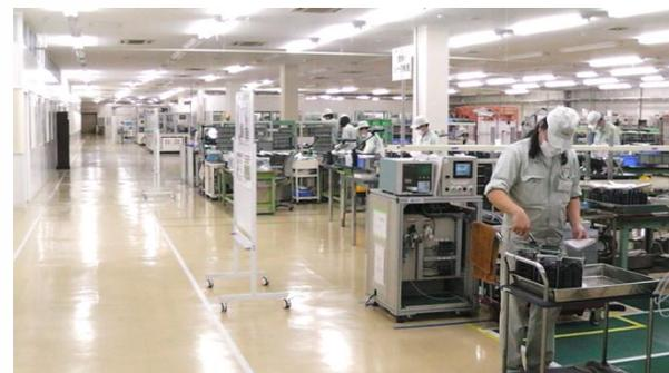
燃料電池ユニット組立・試験(内製)
